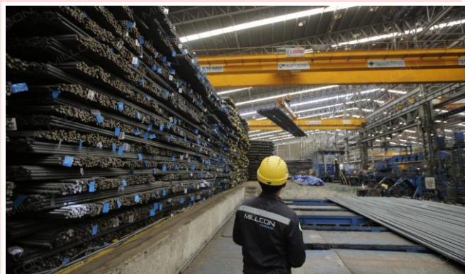
ภาพ : การผลิตเหล็กเส้น เป็นการผลิตขั้นที่สองหรือขั้นทุติยภูมิ ที่มา : https://brandinside.asia/281118_4-01/
